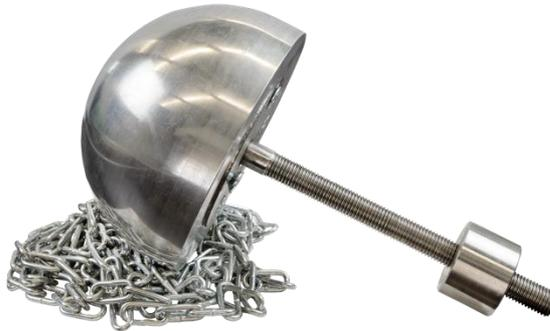
Устройство определение ударного воздействия элементов качания
